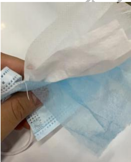
无纺布+熔喷布 3 层结构
